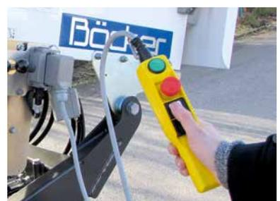
Bedienung unten über Bedienungstaster mit 4 m Kabel
