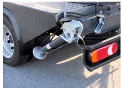
Hydraulische Stützen mechanisch ausziehbar und 60° schwenkbar
