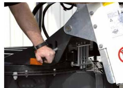
Verstellbarer Drehkranz mit mechanisch lösbarer Sperre
