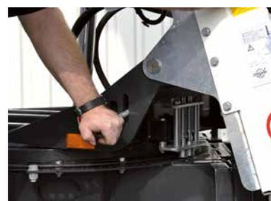
Verstellbarer Drehkranz mit mechanisch lösbarer Sperre
