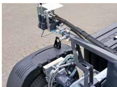
Formschlüssiger, leistungsstarker Selbstfahrtrieb (optional)
