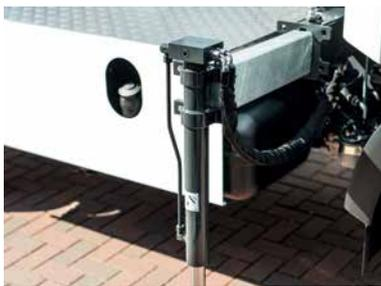
Hydraulische Stützen vorne optional ausziehbar
