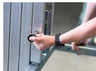
Montage und Fixierung der Lastgabel mittels Kugelsperbolzen
